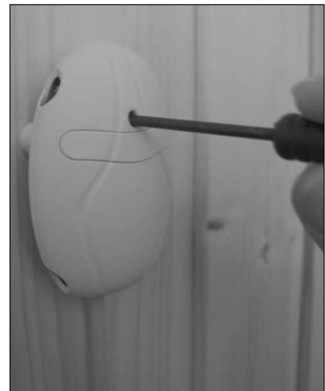
Figure 15. Bouton de réinitialisation du circuit de surchauffe Figuur 15. Reset-knop voor de beveiliging tegen oververhitting
